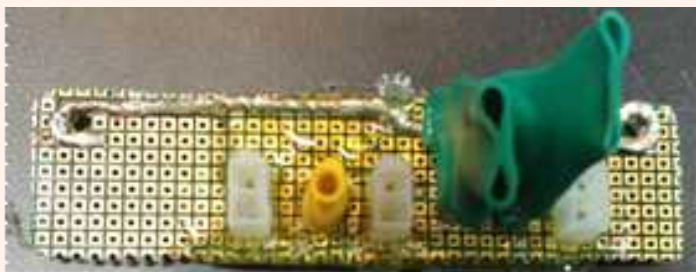
Varistor 470V \varnothing 20 (L-G, N-G), Varistor 430V (L-N)
